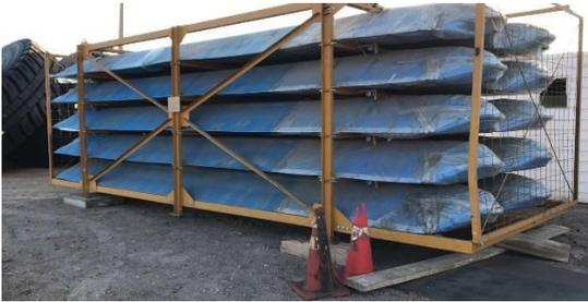
Se puede observar la malla metálica en los extremos de la estructura (correcto), sin embargo, esta no cuenta con las calzas para las uñas de la Grúa Horquilla. Debe tener calzas para poder posicionar la Grúa Horquilla.
