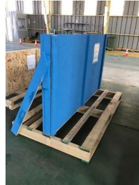
Forma correcta de la posición del pallet con Vidrios (ventanas, parabrisas, espejos, etc.). Para mayor firmeza a la carga en su posición vertical, se requiere fijar vientos de madera hacia ambos lados del pallet.
