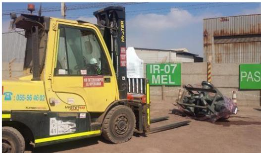
Consecuencia de tomar atril metálico sin las calzas para las uñas. En acción de frenado, estructura puede resbalar sobre las uñas, volcándose produciendo daño a la carga.
