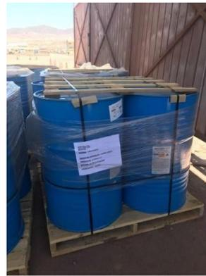
Estructuras de madera en la parte superior de los tambores, que facilita el apriete de los zunchos, evitando que estos se corran de su posición y se pierda la tensión presión sobre el pallet. Asimismo, permite que para el transporte se cruce la faja sobre la rampla. Ambos modelos están correctos.
