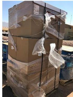
Incorrecto. Deficiente colocación film plástico, con sólo una vuelta.
