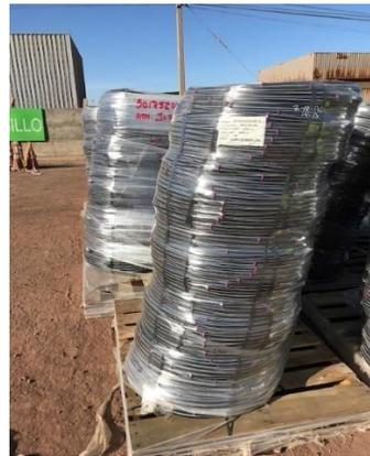
Goteros palletizados con 5 rollos y con dos torres sobre el pallet, lo cual Desestabiliza el palletizado para el transporte y manipulación. Asimismo, las pocas vueltas de film no están tomadas del pallet.
