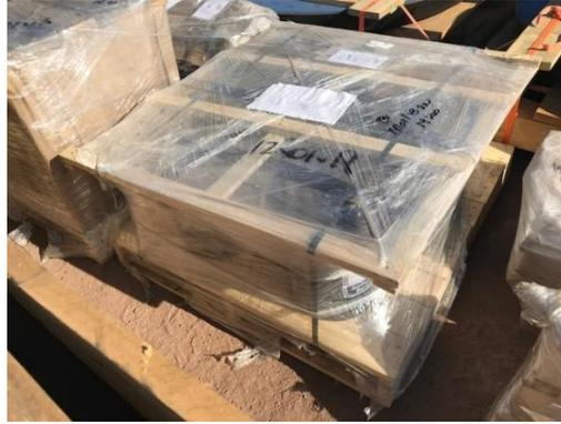
En ambas fotografías se aprecia una correcta la ubicación de marco de madera sobre la carga de componentes de bordes circulares. Con esto se facilita la colocación de los zunchos cruzados y se evita que se desplacen de su centro.
