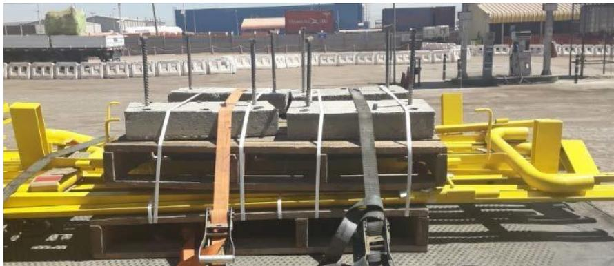
Incorrecto. Pallet remontado y zunchos plástico, lo cual es una sujeción insuficiente Para soporta el peso y la presión de los bloques de cemento. Existe el riesgo que carga se suelte y caiga de la rampla
