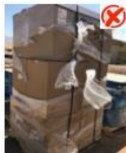
Film dañado y altura super 1,20 mts
