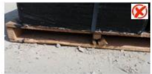
Pallet en mal estado
