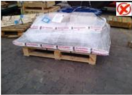
Material fuera de pallet y sin sujeción con zunchos
