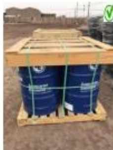
Tambores con zunchos, protección superior y pallets
