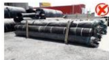
Tubos sin soporte para manipular con grúa horquilla
