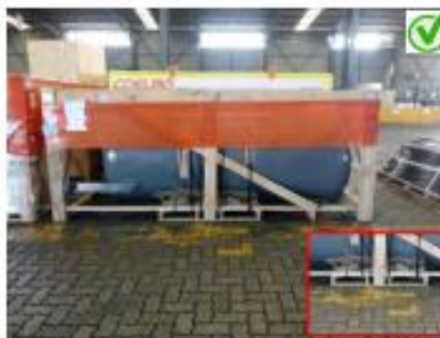
Soporte para manipular con grúa horquilla
