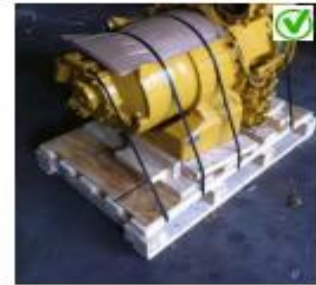
Material irregular con sujeción al pallet
