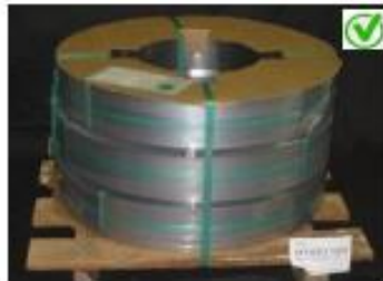
Zunchos sujetan material al pallet
