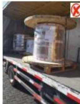
Carga sobresale del pallet
