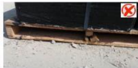
Pallet en mal estado
