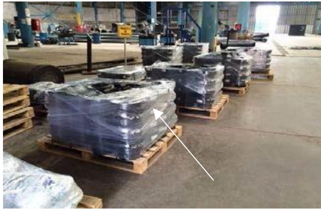
Varias vueltas de film para dar firmeza y estabilidad al material.
