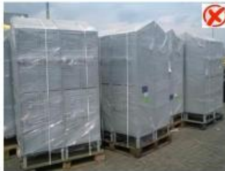
Estructura frágil sin jaba y sin rotulo
