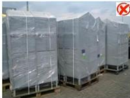
Estructura frágil sin jaba y sin rotulo
