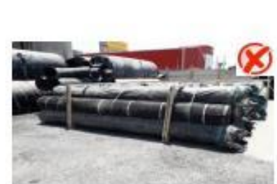
Tubos sin soporte para manipular con grúa horquilla
