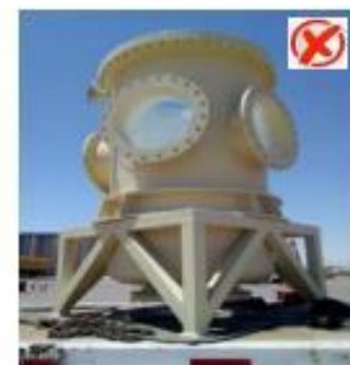
Material sin pallet para manipulación, no es segura la manipulación "fierro con fierro".
