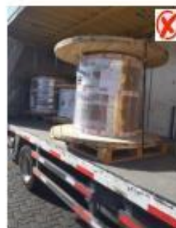
Carga sobresale del pallet
