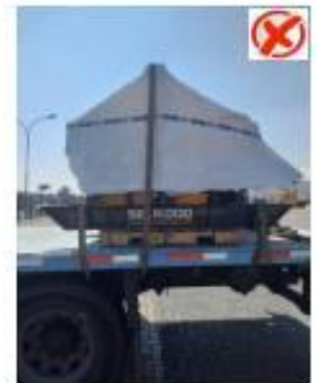
Material no rotulado y no informa el centro de carga, frágil o peso de carga.
