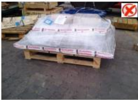
Material fuera de pallet y sin sujeción con zunchos
