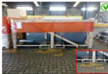
Soporte para manipular con grúa horquilla
