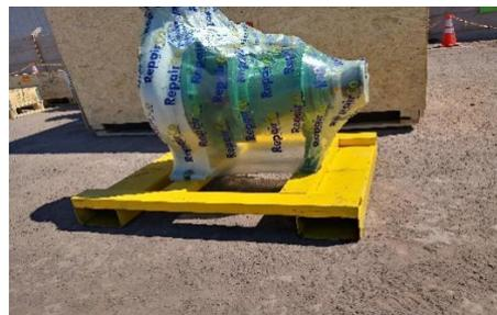
En las fotos dos tipos de fijaciones, para diferentes bases, lo que dependerá del peso del componente. Cinta o faja metálica apernada a base de madera y otra apernada directamente en la base metálica.
