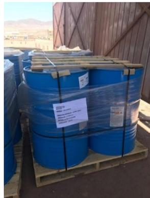
Estructuras de madera en la parte superior de los tambores, que facilita el apriete de los zunchos, evitando que estos se corran de su posición y se pierda la tensión presión sobre el pallet. Asimismo, permite que para el transporte se cruce la faja sobre la rampla. Ambos modelos están correctos.
