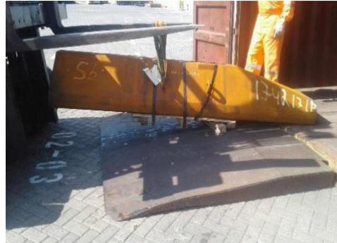
Revestimiento de importación con pallet Palletizar insuficiente para resistir el peso de material
