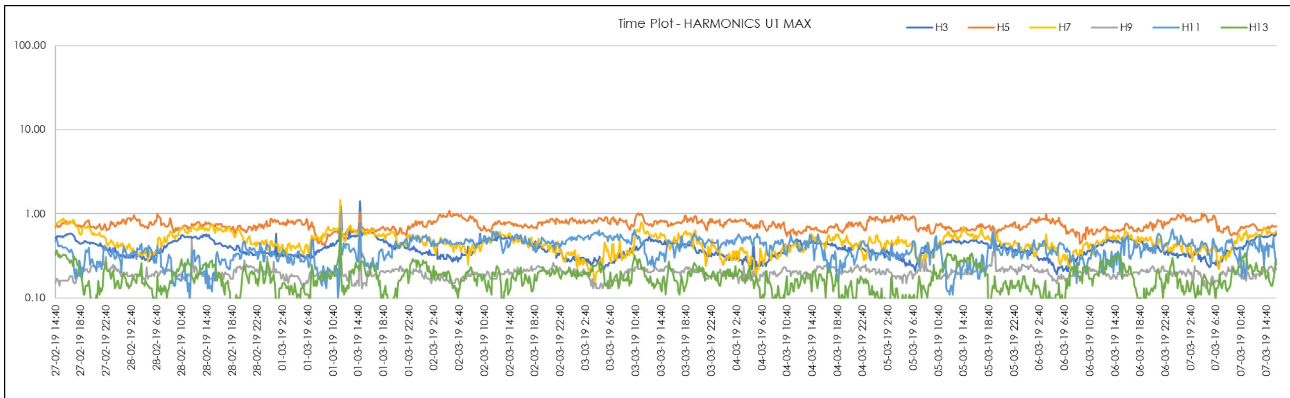
Figure 189 | STS2 End Odd 3<sup>rd</sup>-13<sup>th</sup> Harmonics (Red Phase)
