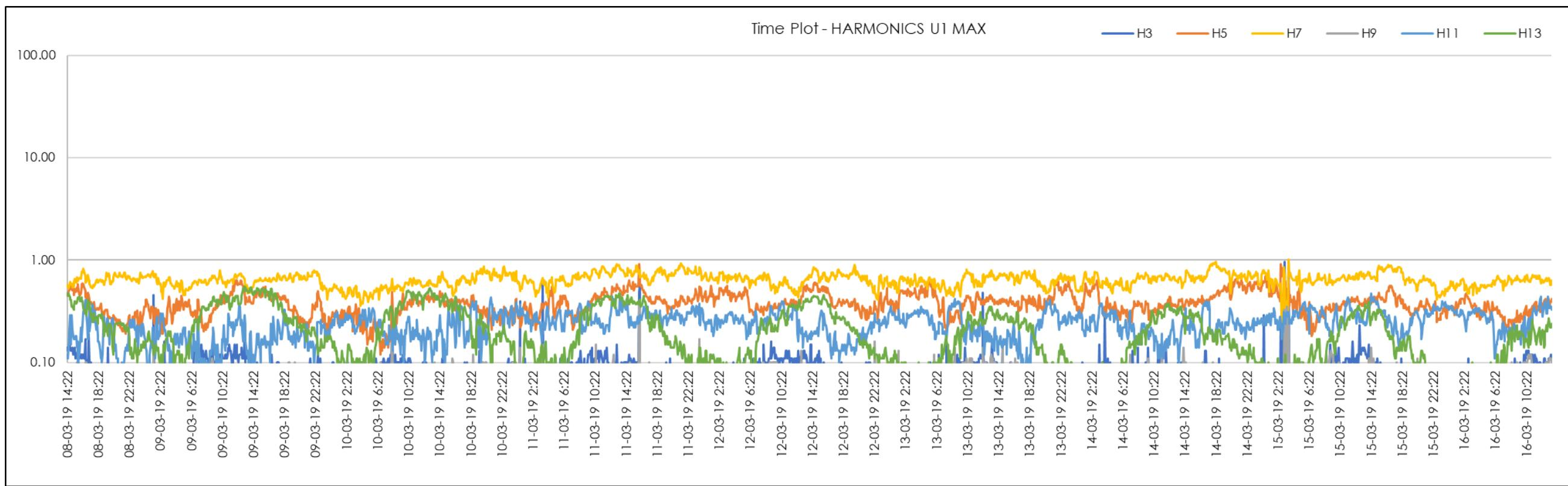
Figure 217 | STS4 End Odd 3<sup>rd</sup>-13<sup>th</sup> Harmonics (Red Phase)
