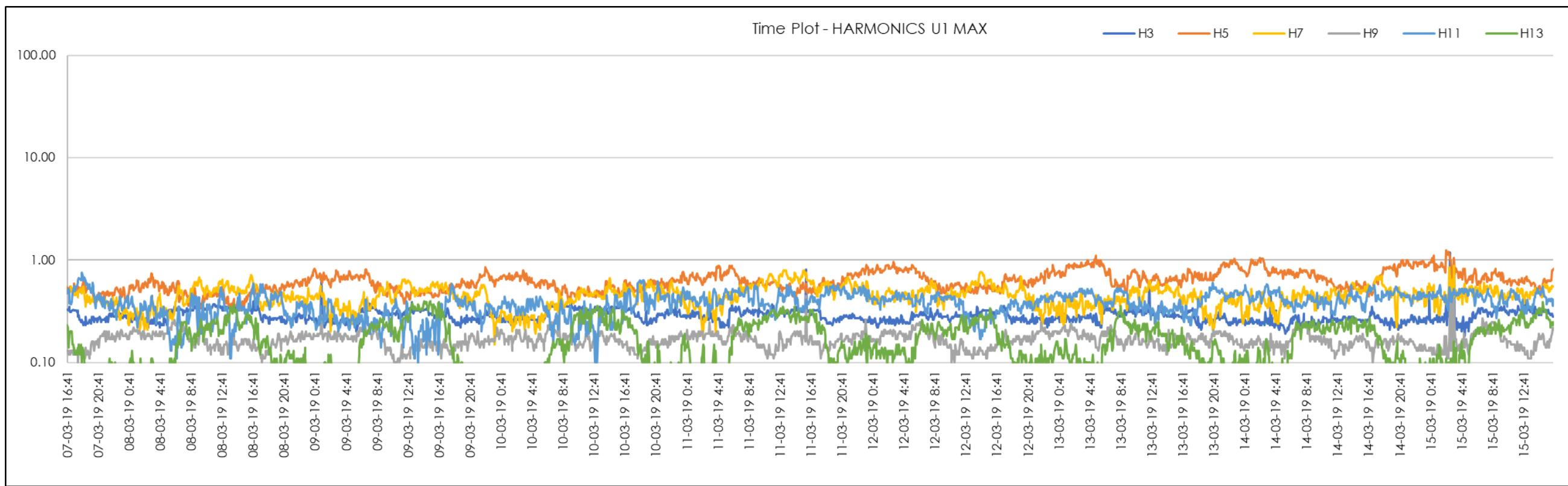
Figure 161 | STS1 End Odd 3<sup>rd</sup>-13<sup>th</sup> Harmonics (Red Phase)
