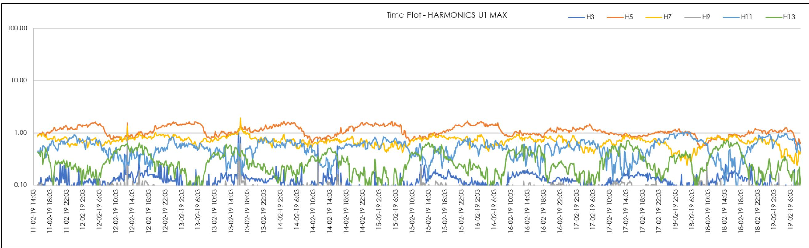
Figure 49 | TC1 End Odd 3<sup>rd</sup>-13<sup>th</sup> Harmonics (Red Phase)
